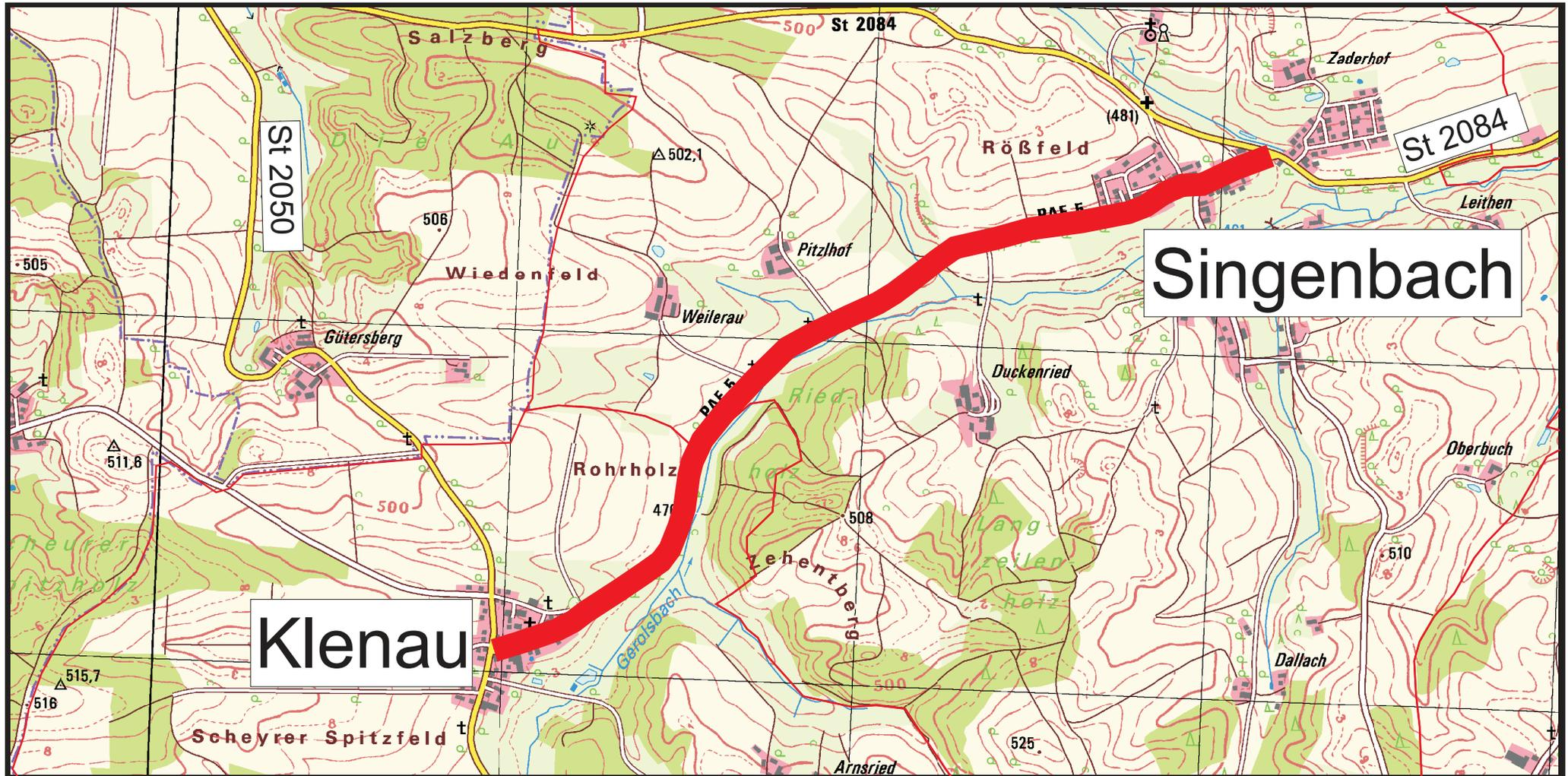
Länge 2.840 m, mittlere Breite 5,56m, max. Breite 32,00m, min. Breite 4,80 m,
